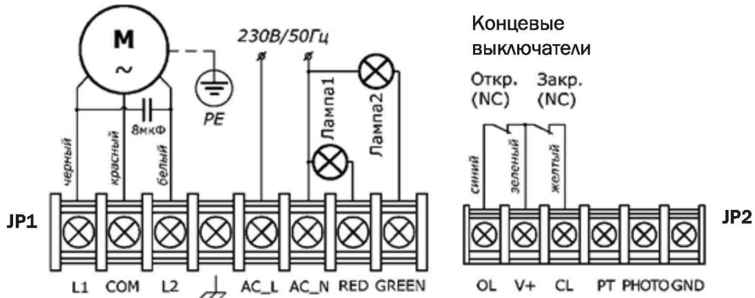
Подведенное защитное заземление выполняйте к специально предназначенному болту в тумбе шлагбаума.
