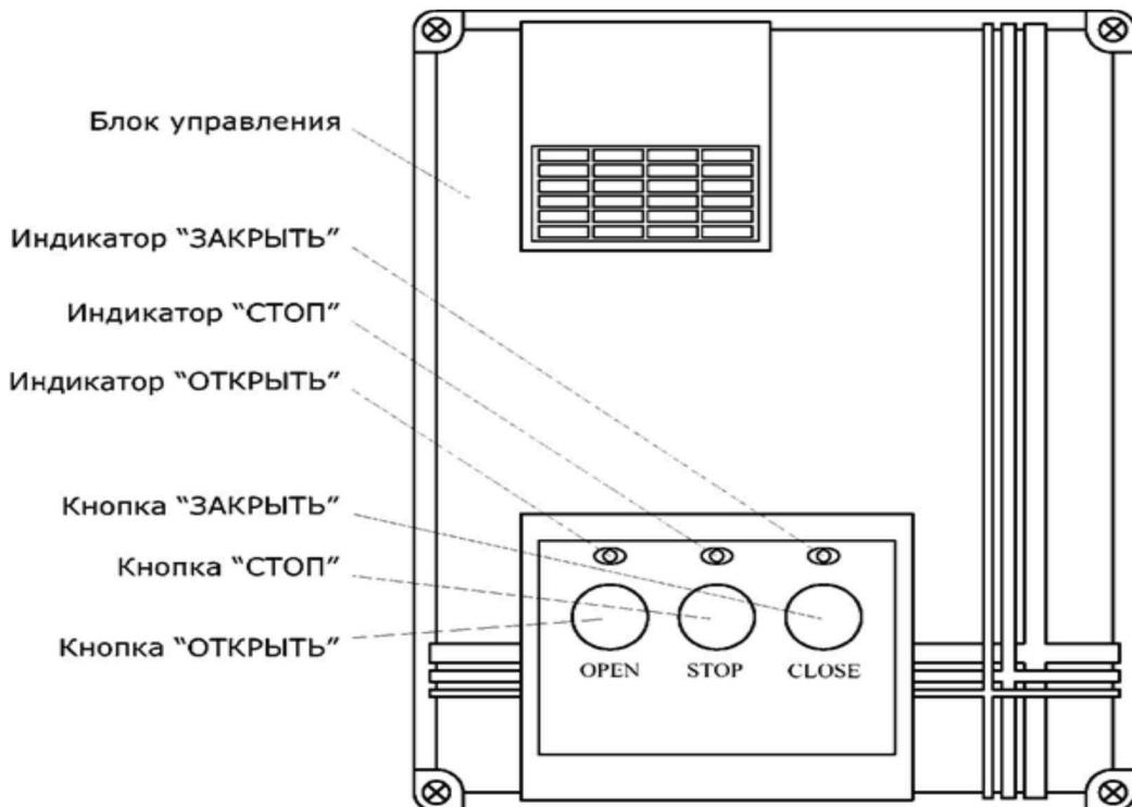
**Назначение элементов на панели блока управления**
