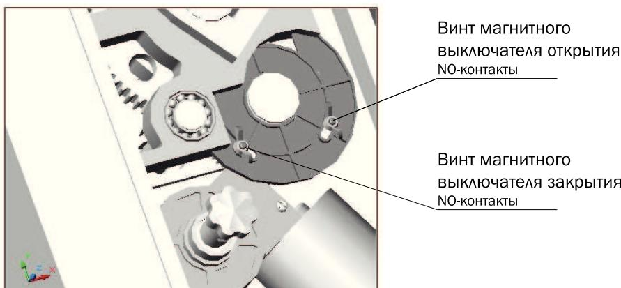
! Микровыключатели/герконы, включаемые в одну контрольную цепь и имеющие нормально-разомкнутые контакты, соединяются параллельно.
